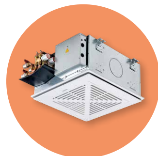
Deckenkassette UCS/H600 Deckenkassette im Euroraster – optional mit Filter der Klasse 7 für hygienisch anspruchsvolle Projekte
