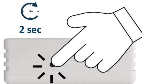
Abbildung 2.8 Vorgang zum Ändern des WLAN-Kanals
