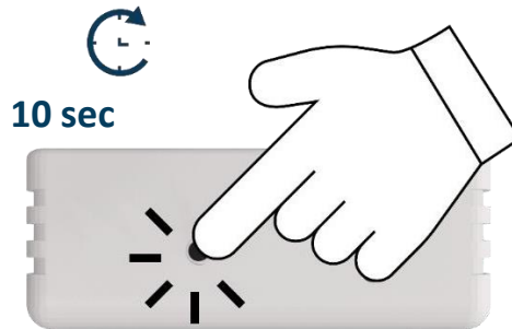
Abbildung 2.4 Vorgang zum Zurücksetzen der WLAN-Einstellungen
